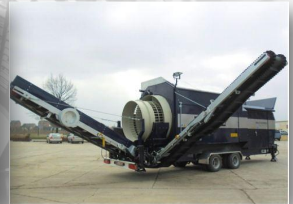
Verlängerte Haldenbänder Für Zwischen- und Grobfraktion
